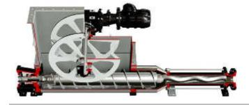
Versión dotada de tolva rectangular, con protección de las articulaciones y cóclea ancha de alimentación de la parte hidráulica. En la tolva está instalado el Módulo "B" que gracias a un dispositivo de rueda, alimenta la cóclea evitando la formación del puente. Apropiada para bombear sustancias no fluidas hasta el 40% de sustancia seca que tienden a formar puente y a plastificarse.
