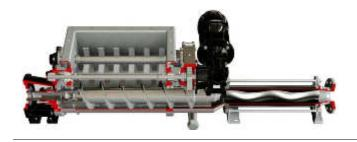
Versión dotada de tolva con doble árbol rompe-puente, con protección de las articulaciones y cóclea sobredimensionada de alimentación de la parte hidráulica. Apropiada para bombear sustancias no fluidas hasta el 35% de sustancia seca de altísima viscosidad que tienden a formar puente o en bloques.
